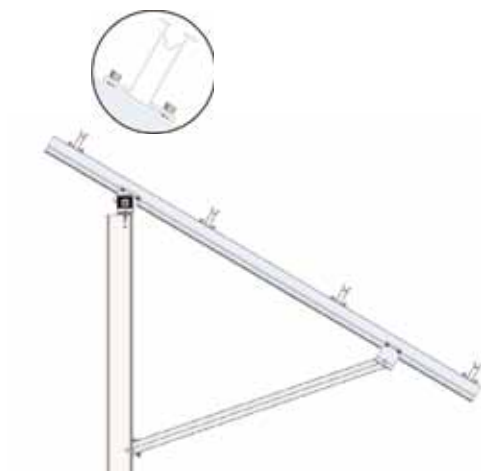
4：レール固定金具でレールを取り付ける
