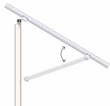
3：フレームと角度調整部品を取り付ける
